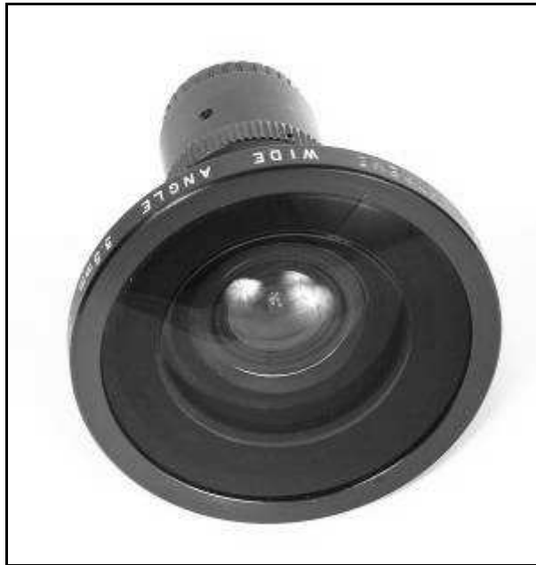
illustration 12: Fisheye Century 3.5mm monture type C pour caméras 16 mm. La pupille d’entrée est quasiment invisible
