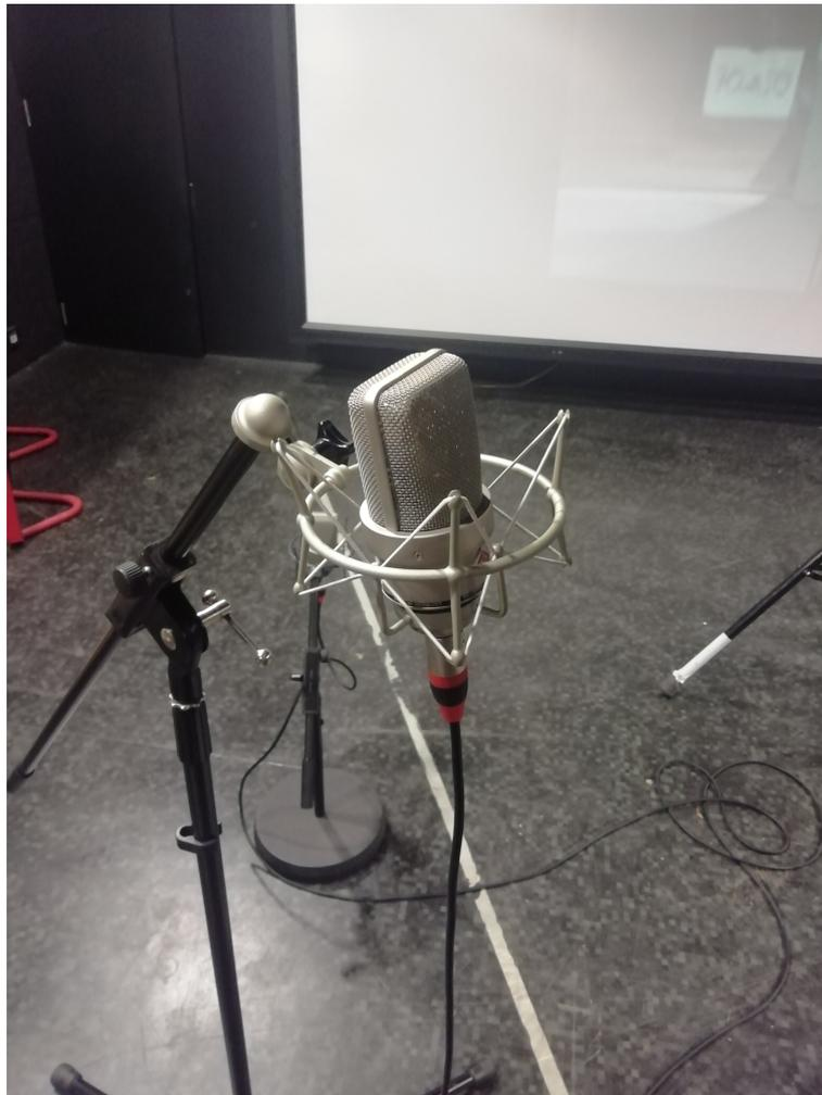
FIGURE 3.3 – Microphone Neumann TLM 103, placé sur un pied de microphone dans l'auditorium de mixage de l'ENS Louis-Lumière.
