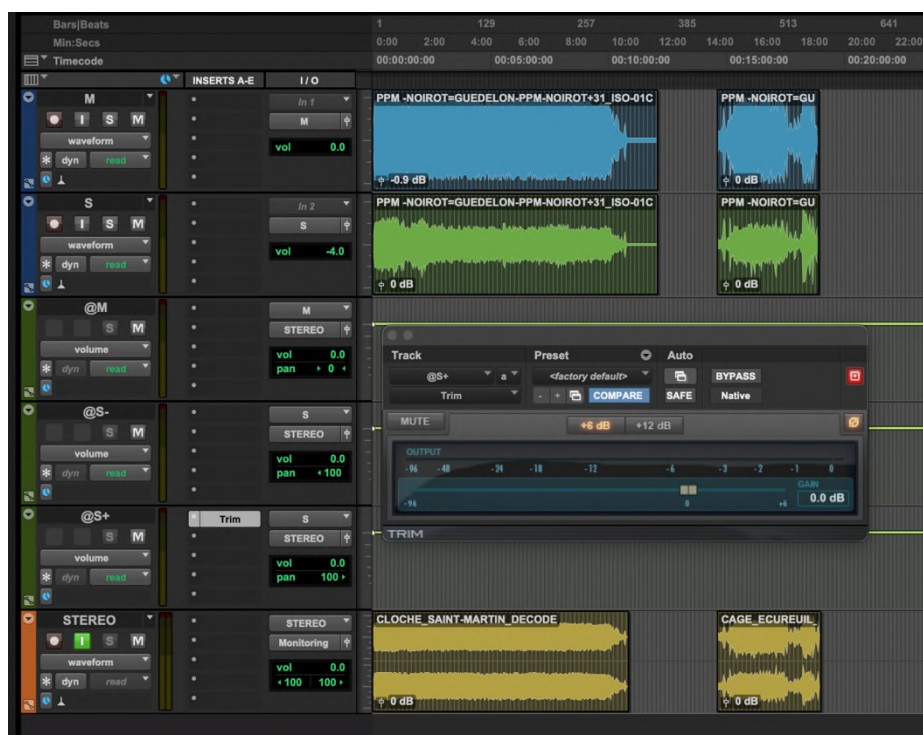
Figure 19 : Décodeur Mid Side (M+-S) avec Pro Tools
