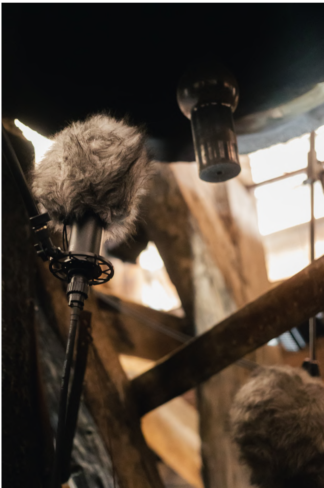
Figure 33 : Photographie de la mise en place du système de prise de son de la cloche de 1517 du temple Saint-Martin avec le micro Scheeps MS et l'Oktava ambisonique par Céline Bouquet
