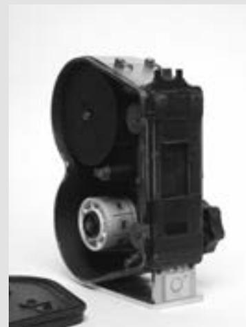
La carton chargement d'une bobine 24x36 / FM35S chargée avec une bobine de 30m.
