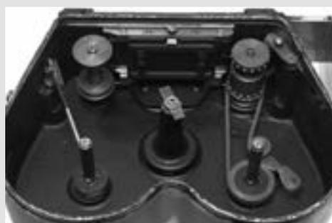
FM35S, poignée crantée, détail roulement à bille / Roue d'entraînement & courroie de transmission.
