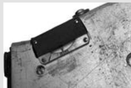
FM35S, jauge à palpeur / Bobine de 30 m en place / Compteur métrique par 5 m.
