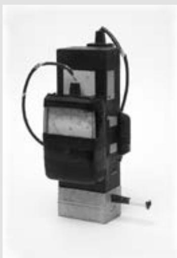
La carton, le luxmètre (1 lux = la quantité de lumière reçue par un panneau blanc, d'un mètre carré, éclairé par une bougie, placée à 1 mètre du panneau blanc)
