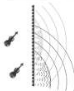
WAVE FIELD SYNTHESIS on peut synthétiser le champ sonore de sources « virtuelles » à l'aide d'un banc linéaire de haut-parleurs
