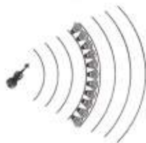
PRINCIPE DE RAYLEIGH les fronts d'onde émis par la source primaire se comportent comme un ensemble de sources secondaires
