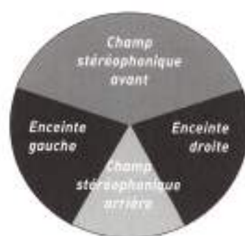
FIGURE 3 ZONES REMARQUABLES EN CAPTATION STÉRÉOPHONIQUES. LE CENTRE DU CERCLE CORRESPOND AU COUPLE STÉRÉOPHONIQUE.
