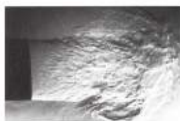
FIGURE 3 VISUALISATION DE L'ÉCOULEMENT EN SORTIE D'UN ÉVENT DE HAUT-PARLEUR PENDANT LA PHASE DE FLUX SORTANT 16
