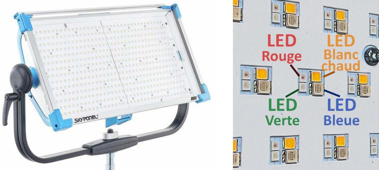
Figure 1.16 (a, b) : Dalles LED d'un SkyPanel S60-C / Gros plan sur les LED d'un SkyPanel (RGBW)
