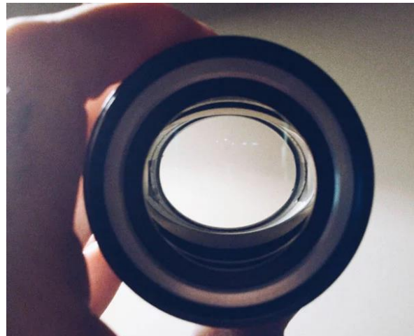
Figure 52, Pupille de sortie d'un objectif anamorphique, Les Numériques, "Qu'est ce que la prise de vue anamorphique?", 2023
