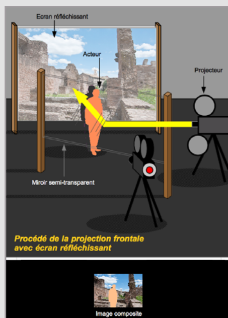
Illustration 16 Schéma illustrant le procédé de la projection frontale sur écran réfléchissant. Tous droits réservés Jean Guibouret.
