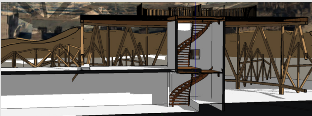
Fig. 4 Coupe sur le cylindre de l'escalier, détail de la fenêtre. - ill.Lescop – 2016
