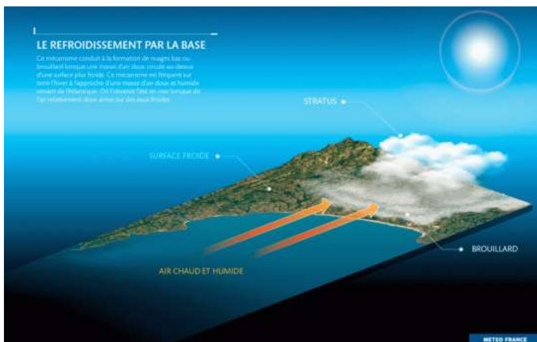
Figure 11 – Le refroidissement par la base, à l'origine du brouillard d'advection (Source : Météo-France, https://meteofrance.com/comprendre-la-meteo/nuages/comment-se-forme-un-nuage )
