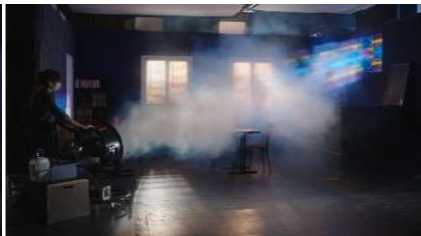
Figure 92 – Viper NT à 100% de puissance, avec ventilateur à 40/50 de puissance.
