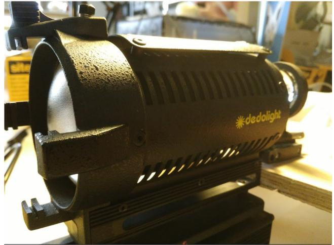
Projecteur Dédolight en phase de changement de lampe (celle-ci se glisse entre le miroir et la lentille mobile visible ci-contre).
