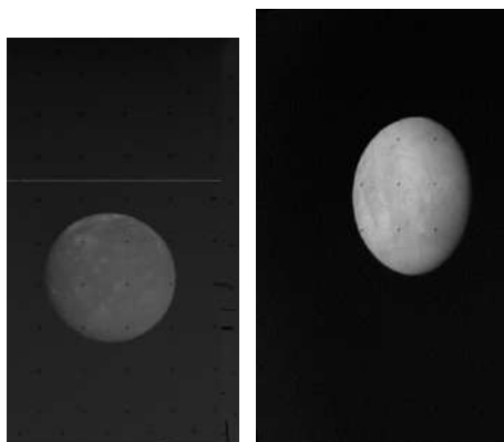
Fig. 38 1ère image : Titania (Uranus) à 280 lux et 1440 ms Fig. 39 2ème image : Europa (Jupiter) à 3700 lux et 120 ms
