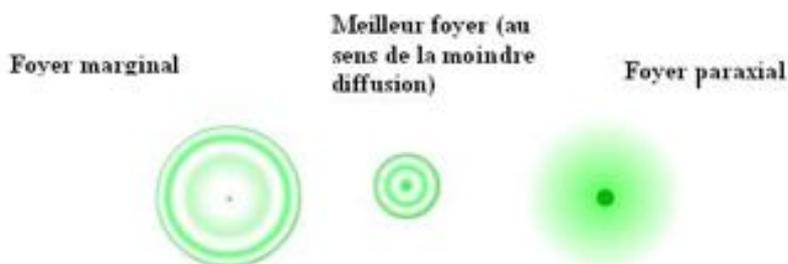
FIGURE 2.4 – Tâches image avec l'aberration sphérique
