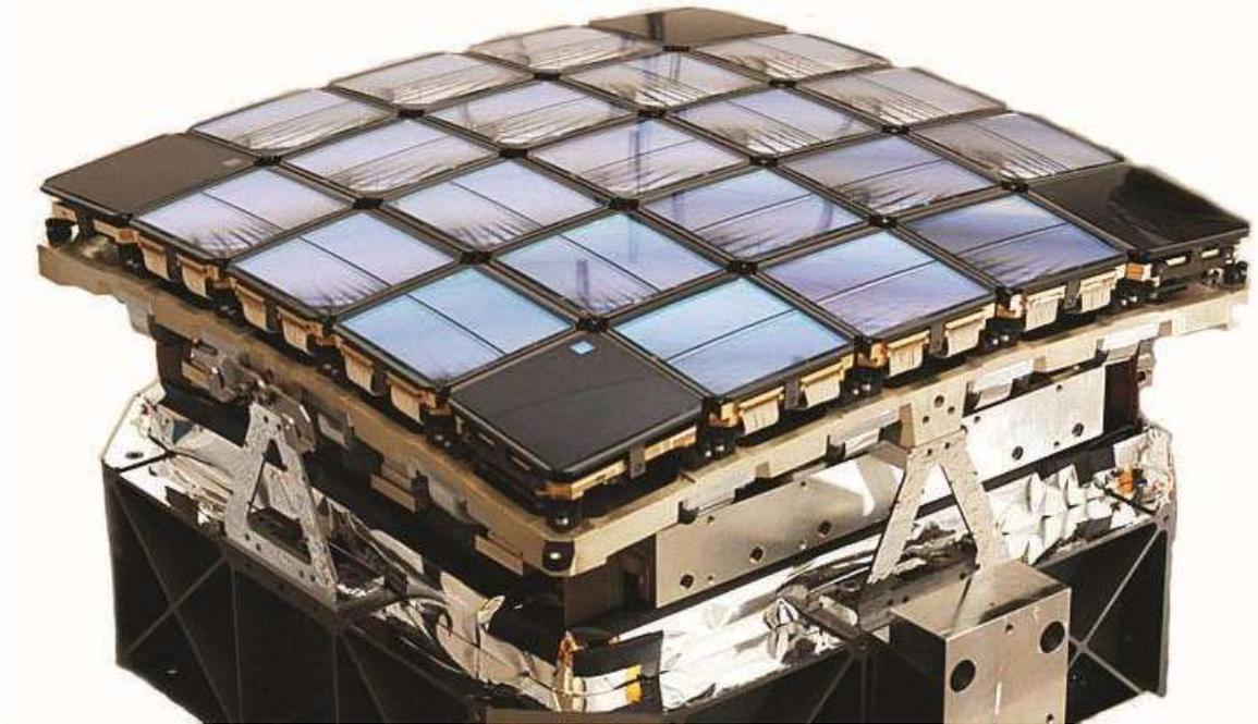
Illustration 91 : Réseau convexe de capteurs plans du télescope spatial Kepler
