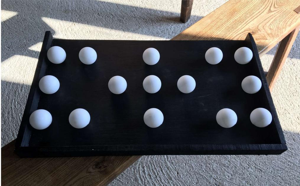
Illustration 45 : Mire volumique réalisée avec des sphères régulières de diamètre 40mm, qui sont de simples balles de ping-pong. Dimensions de l'ensemble : 30x50cm
