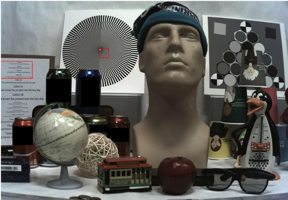
Illustration 93 : Image produite par le capteur prototype Microsoft Vermont Project
