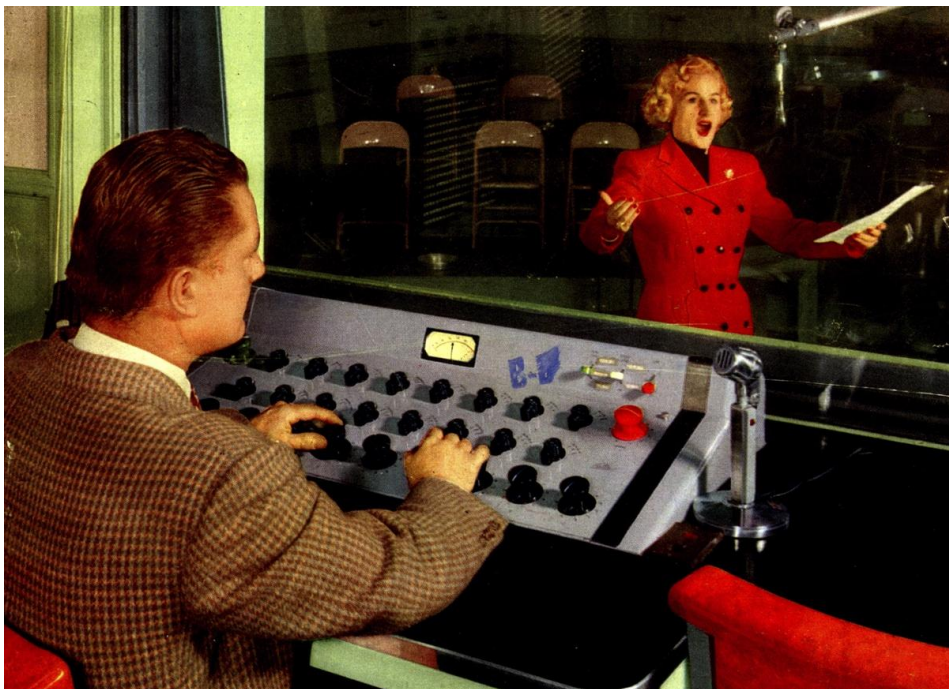
“Cinema Engineering Console” avec égalisation. Ici utilisé pour Radio & Television News, 1951 studio Capitol Records http://www.preservationssound.com/2012/02/audio-mixing-consoles-circa-1959/
