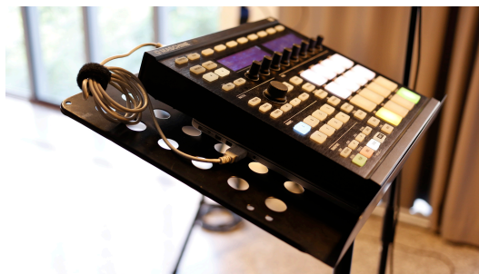
Figure 37 - Maschine MK2 connectée en USB à un Macbook Pro; communication MIDI sans fil avec l'ordinateur de régie
