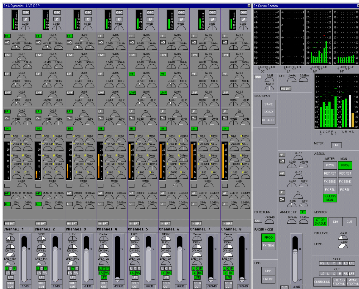
Figure 5 – L'Interface Utilisateur de la Console de Mastering Proposée par la Carte DSD-Wide [P. Thorpe et al. 2001, Figure 15, p.12]
