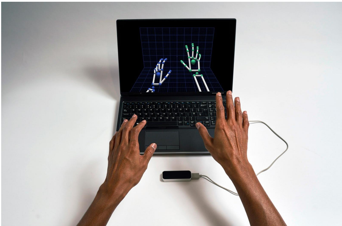
Figure 22 - Photographie des données reçues par le Leap Motion Controller modélisées sur un écran (Ultraleap, 2021)
