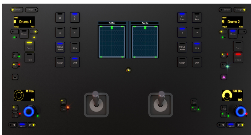
Figure 18 - Module de spatialisation avec 2 joysticks de l'Avid S6 (Avid, 2020)
