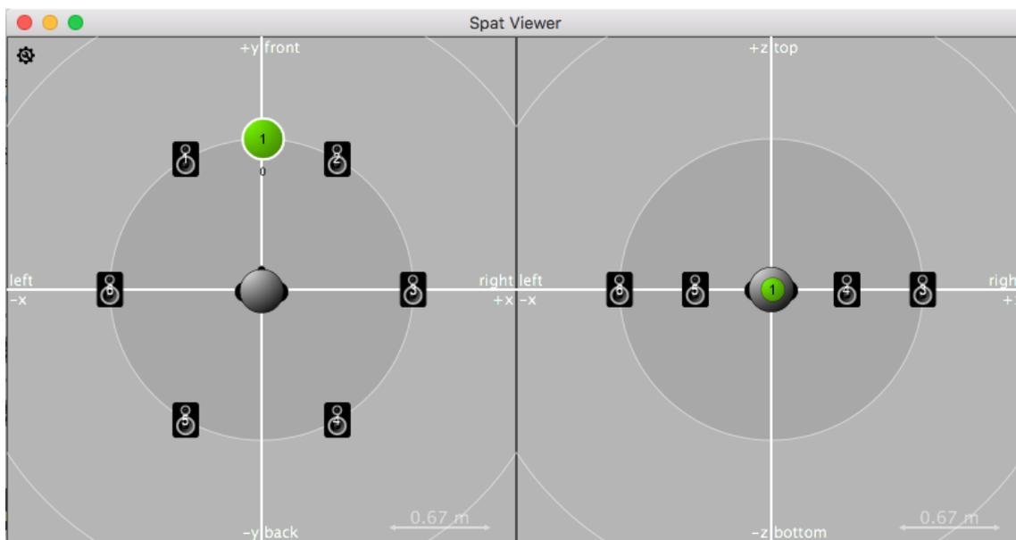
FIGURE 2.23 – Exemple de dispositif VBAP 2D sur 6 HP, 60 degrés entre chaque enceintes (Spat)
