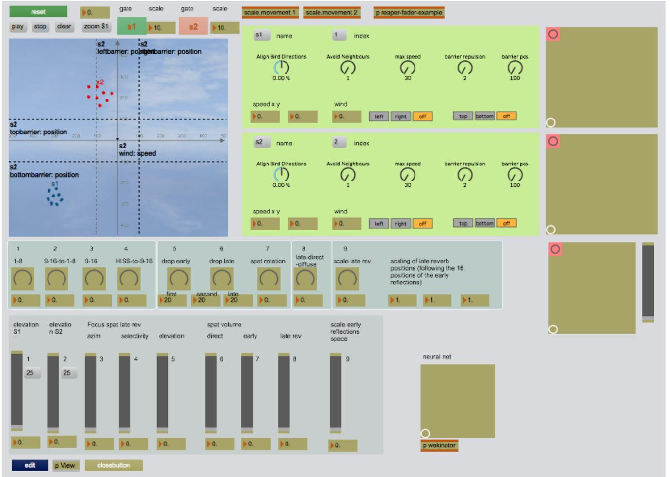
FIGURE 3.51 – Interface de contrôle du simulateur d'acoustique "perceptif", en haut à gauche la position des "oiseaux", à sa droite les contrôles de l'algorithme de *boids*, tout à droite un contrôle du décalage du centre des nuées d'oiseaux, en dessous les potentiomètres rotatifs et faders de contrôle de l'acoustique (temps de réverbération, équilibre des groupes, etc.)
