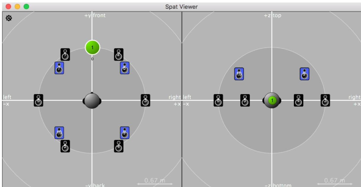
FIGURE 2.25 – Exemple de dispositif LBAP en deux couches, une à 0 degré d'élévation de 6 enceintes et une à 30 degrés d'élévation de 4 enceintes.
