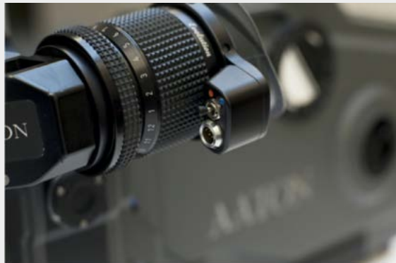
Fig. 4 : Penelope : viseur dioptrique avec système chauffant - Source : Aaton. Pierre Michoud
