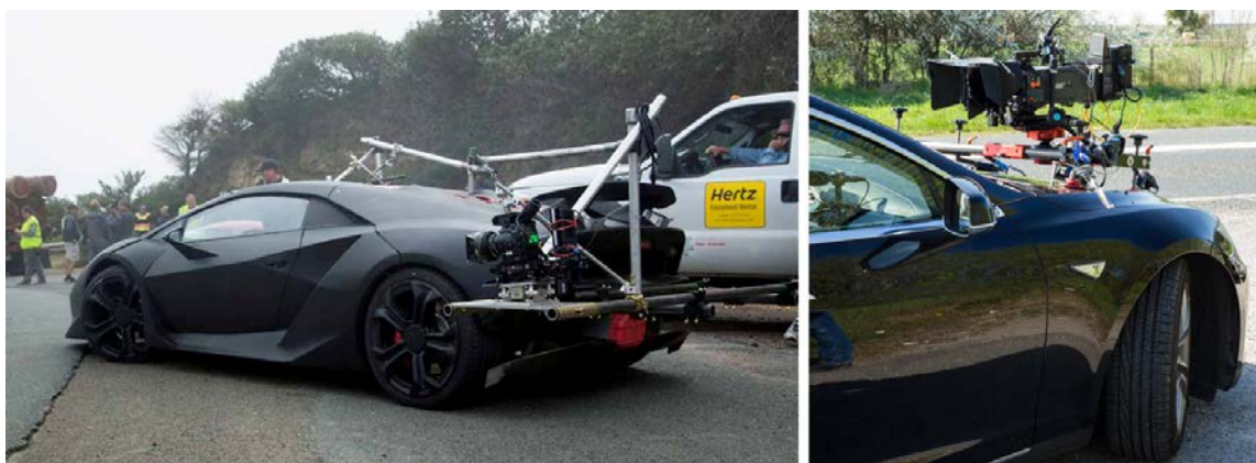
illustration 24 - Sony C500 installée sur une Lamborghini pour Need for speed (© Shane Hurlbut) | speedgrip II (Camagrip) sur une Tesla pour le tournage de la partie pratique de ce mémoire (© Oumeya El Oudie)
