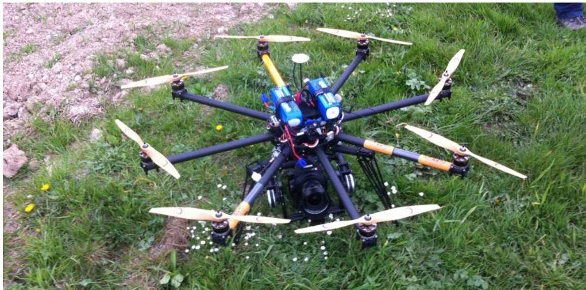
illustration 37 - le drone de prise de vue, équipé d'une caméra Canon C100 et d'une optique Zeiss 21mm EF
