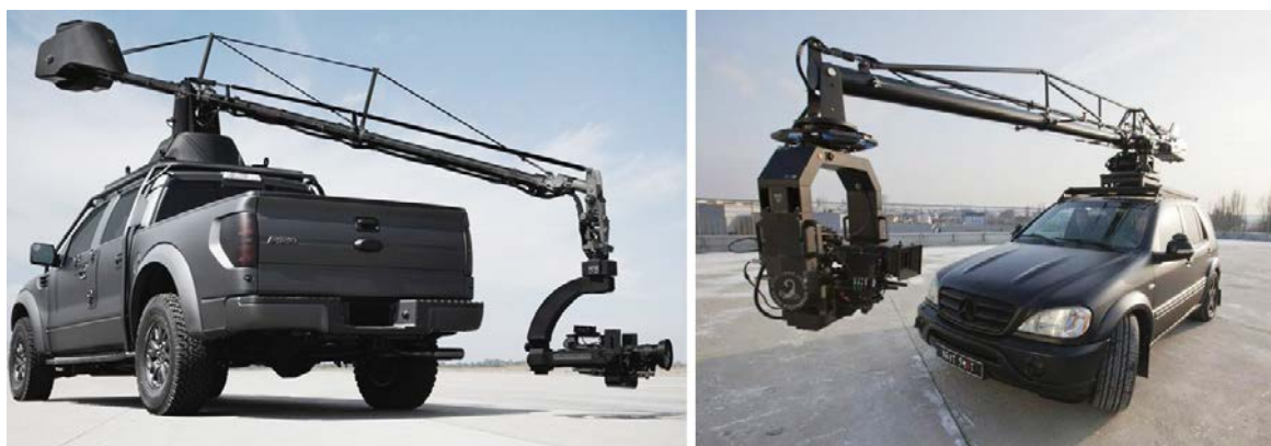
illustration 22 – Russian Arm (Filmotechnic, Russie) 109 | Scorpio Arm sur Mercedes ML (© Next Shot, La cité du cinéma)
