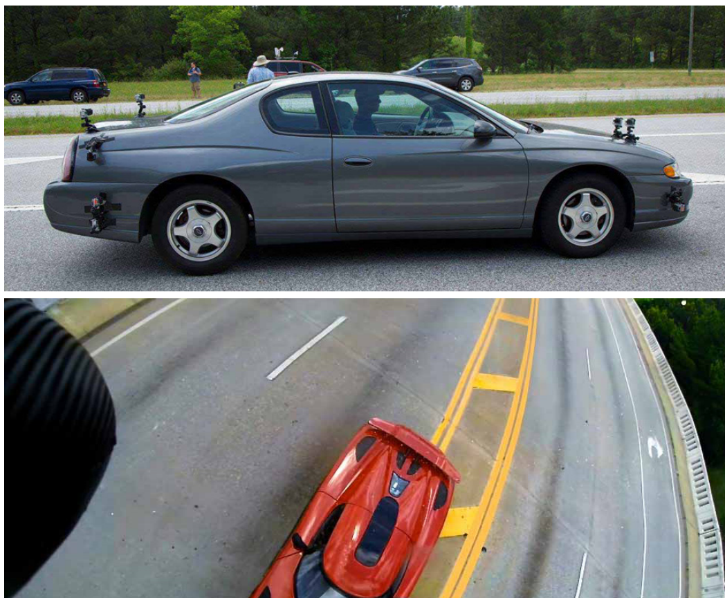
illustration 25 – GoPros pour prise de vue de cascade - en bas, photogramme issue d'une GoPro lors d'une cascade 118
