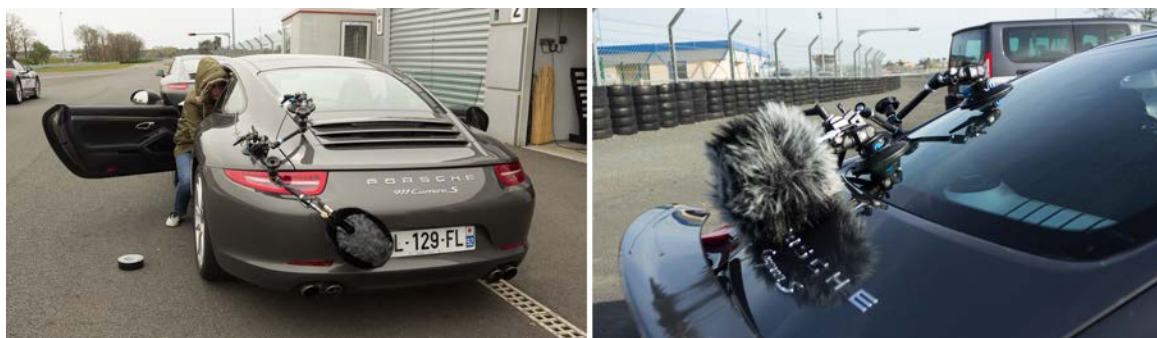
illustration 35 - installations des microphones embarqués sur les Porsche - Le Mans
