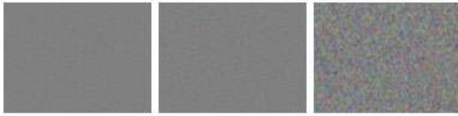
Figure 48 – Images bruitées. Même valeur de gris, écart type en augmentation de la gauche vers la droite. (Gauche : \sigma=2 , centre : \sigma=4 , droite : \sigma=9 ) 78
