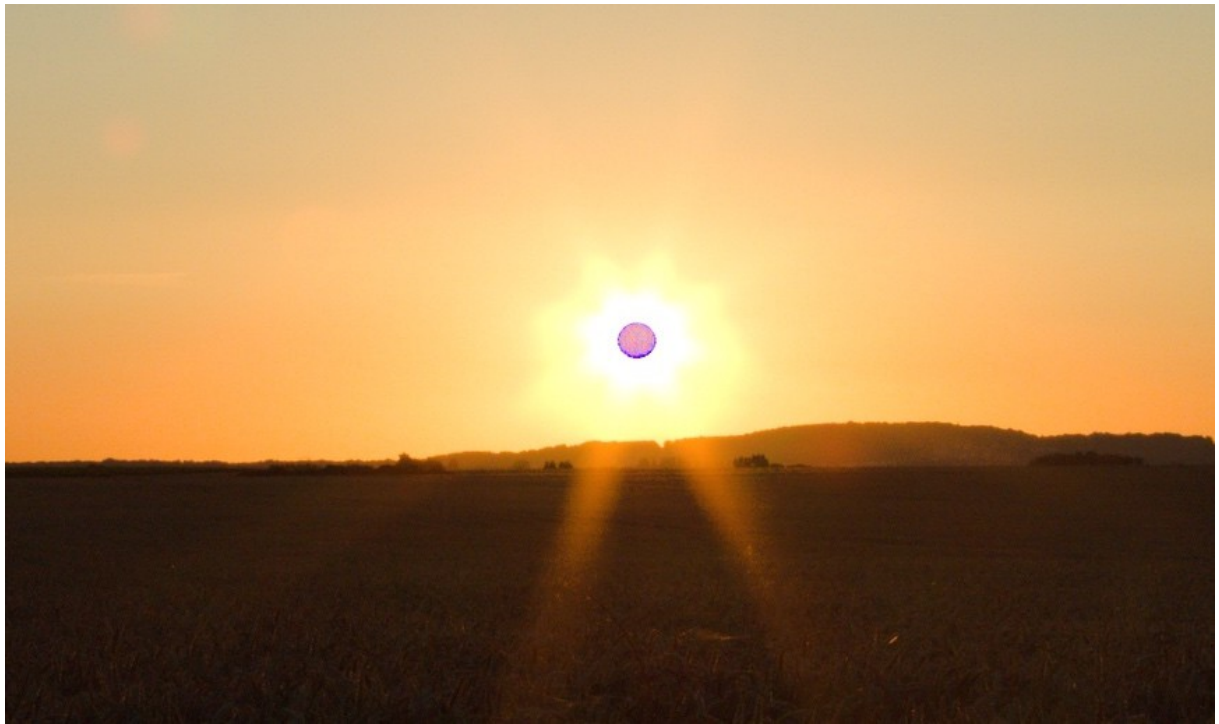
Figure 40 : Phénomène du Black Sun/Black Spot sur un photogramme issu d'une séquence RAW de la Blackmagic Caméra Production 4K N°2271677.
