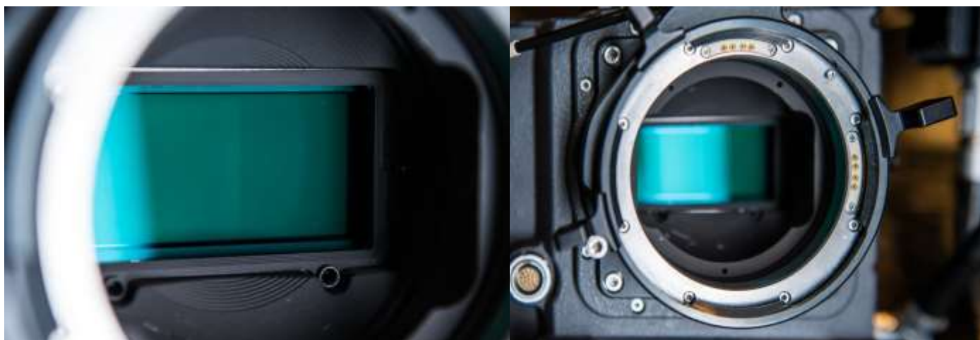
17. Capteur et monture de l'Alexa 65
