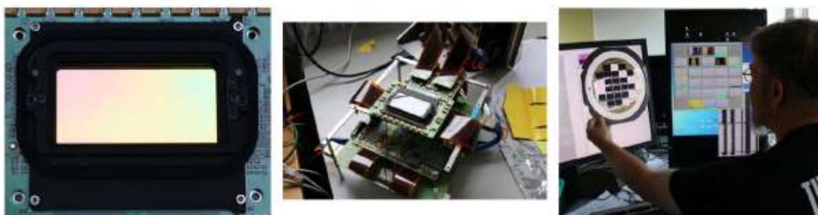
18. Images du capteur Arri A3X CMOS Sensor (Jon Fauer, Film and Digital Times #65: Alexa 65, Septembre 2014)
