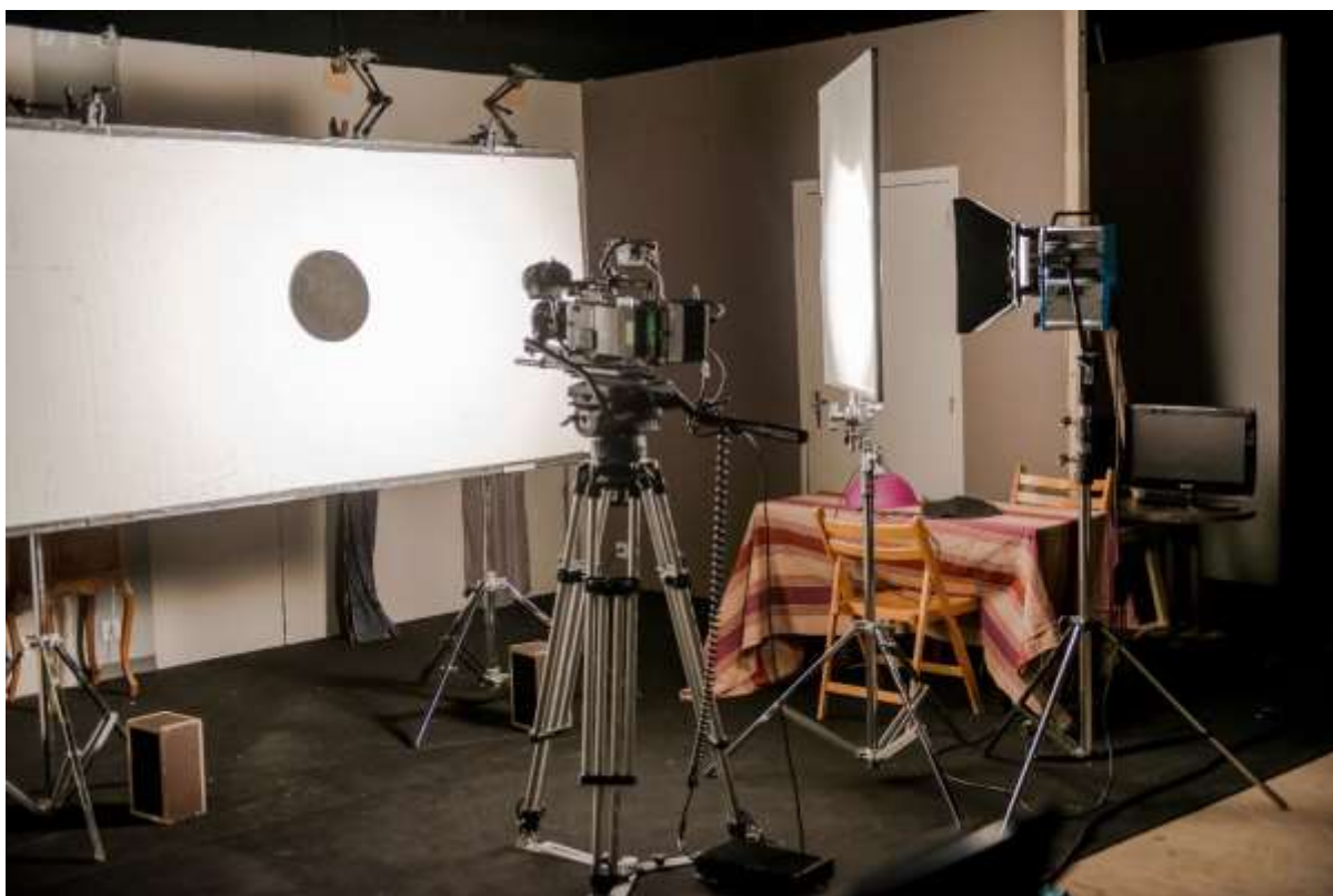
37. Expérience de mise en évidence de l'effet de papillotement avec l'Alexa 65
