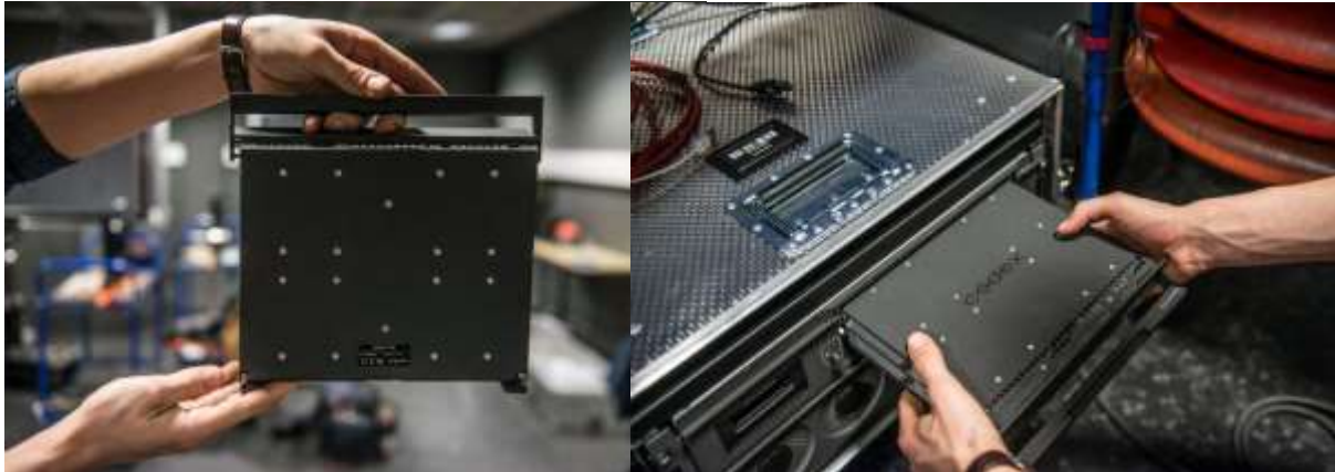
23. Transport Drive 8 To porté, et en cours d'éjection du Vault
