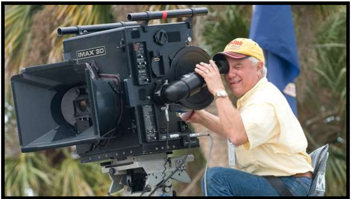
29. Caméras Imax 3D (deux bobines de 65 mm 15 perforations défilent dans la caméra).
