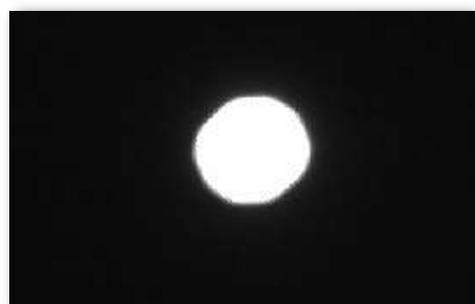
Figure 33 : image de la tâche lumineuse donnée par un Cooke mini s4i 32mm.
