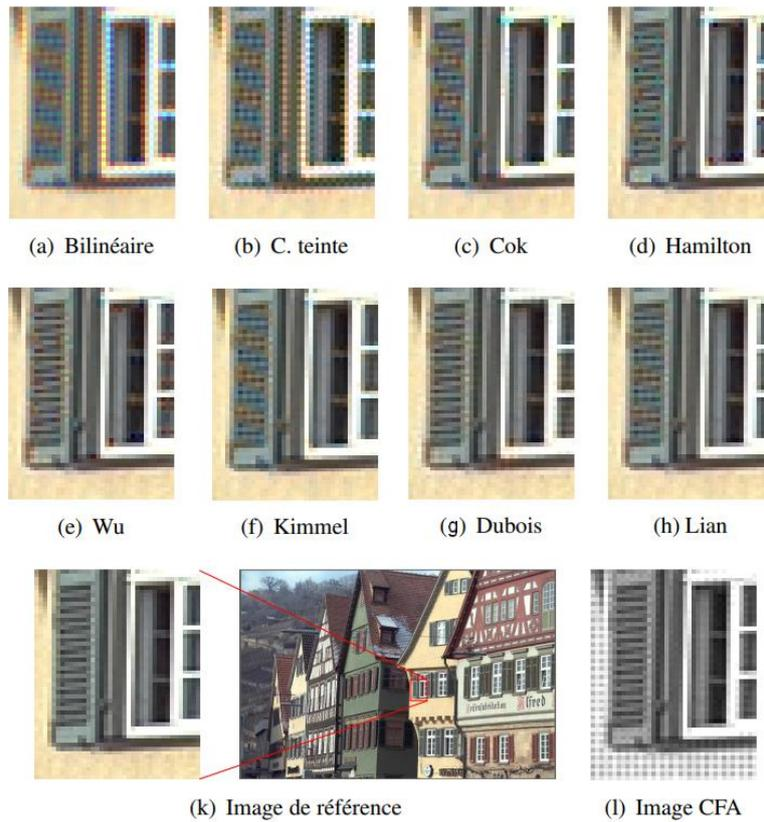
Figure 2.11. Rendus de différents algorithmes de démosaïquage. (a) à (b) méthodes basiques, (c) à (f) méthodes d'analyse spatiale, (g) et (h) méthodes d'analyse fréquentielle<sup>61</sup>.
