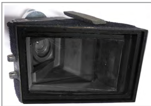
objectif Ultra Panavision 70 équipé de son système à double prismes anamorphoseurs
