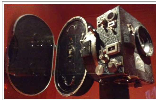
Caméra 65mm Magnifilm développée par André Debrie pour la Paramount. L'image est impressionnée sur un film 65mm mesurant 46x23mm sur cinq perforations. Exposition La Machine Cinéma , Cinémathèque Française, 2016
