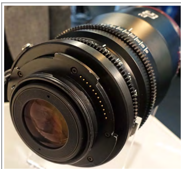
Monture SP 70 des objectifs Panavision Primo 70 de diamètre 66mm plus important que celui de la monture classique Panavision de 49,50mm.
