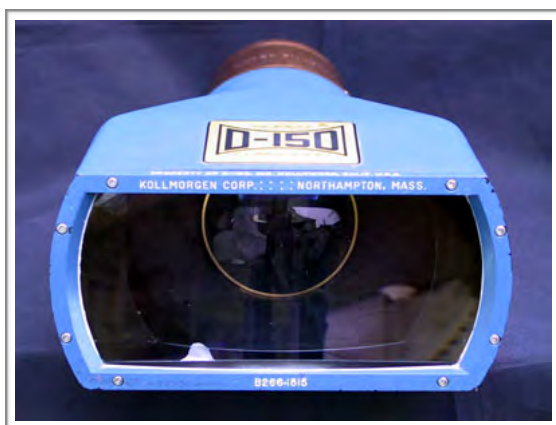
L'objectif Curvulon conçu pour la projection en Dimension 150, développé en 1964 par la Kollmorgen Corp
