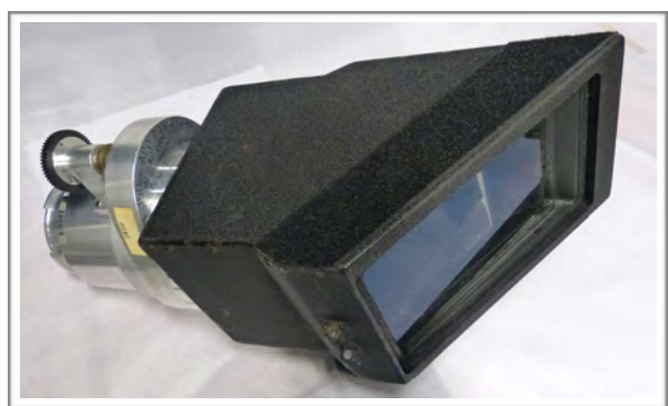
objectif Ultra Panavision 70 équipé de son système à double prismes anamorphoseurs
