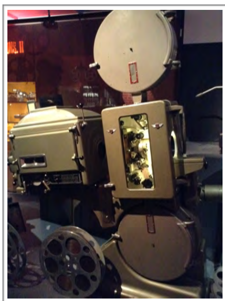
Projecteur bi-format 35/70 développé par Philipps Exposition La Machine Cinéma , Cinémathèque Française, 2016
