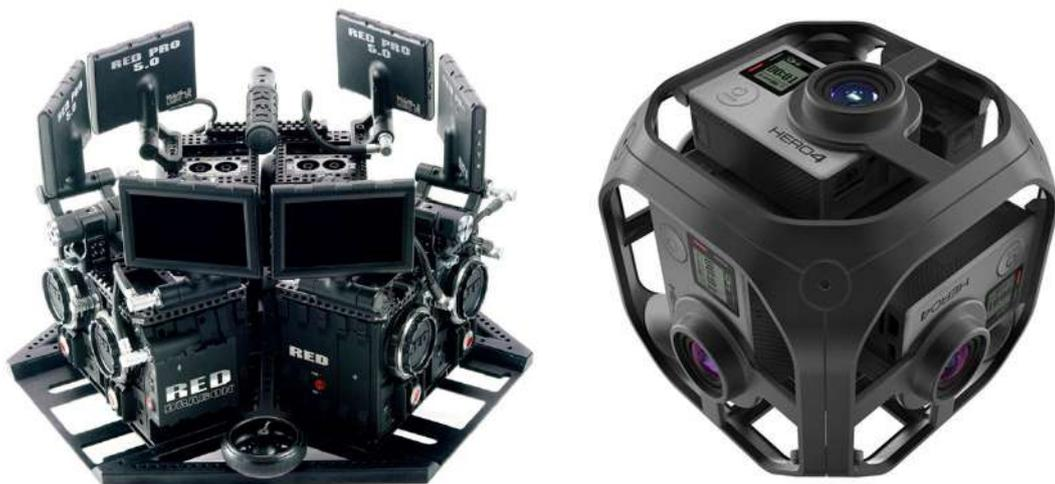
Fig. 20. Image de deux systèmes « composés » permettant de filmer à 360° (à gauche : rig sur mesure assemblant six caméras RED Epic Dragon, à droite : l' « Omni VR » ; rig standardisé présentant 6 caméras GoPro HERO4)
