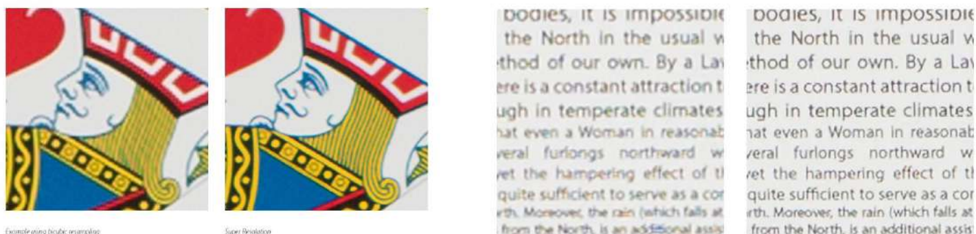
Fig. 29 : Exemple de ré-échantillonnage bicubique (à gauche) et Super Resolution (à droite), exemple obtenu via le billet d'Eric Chan, [en ligne], URL :
