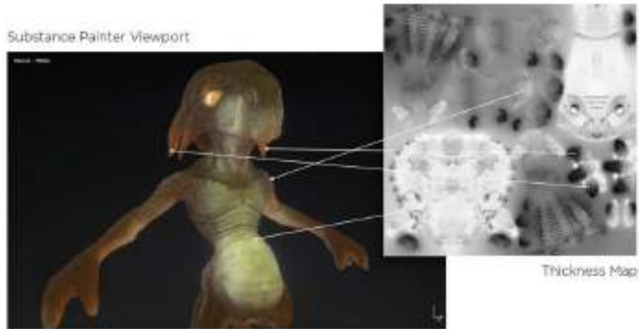
FIG. 13 – illustration d'une map de thickness et son impact sur le modèle 3D, « Thickness map used with subsurface scattering with Substance Painter », 2018, The PBR Guide, © Allegorithmic
