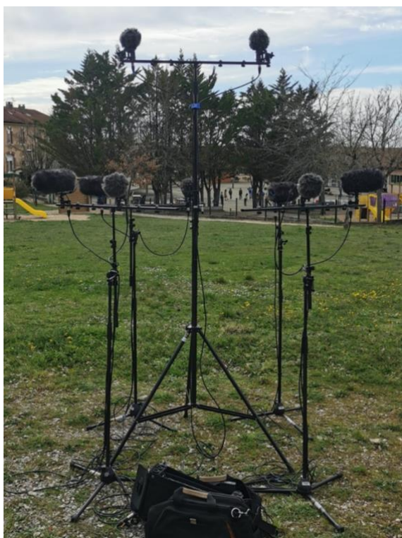
Figure 20 : Photographies du dispositif 7.0.2 pour l'enregistrement des ambiances « École primaire » et « Forêt de pins »
