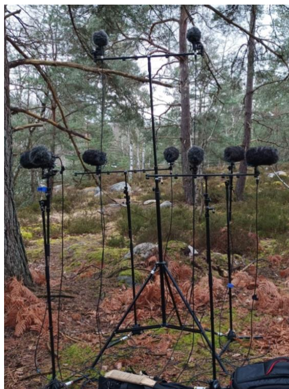
Figure 20 : Photographies du dispositif 7.0.2 pour l'enregistrement des ambiances « École primaire » et « Forêt de pins »
