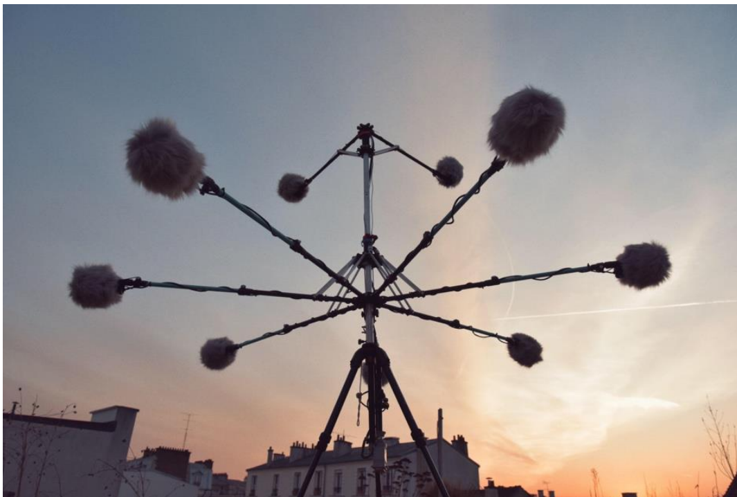
Figure 17 : Photographie de l'arbre Atmos de HAL Audio
