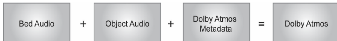
Figure 5 : Schéma bloc simplifié des modèles audio utilisés dans Dolby Atmos
