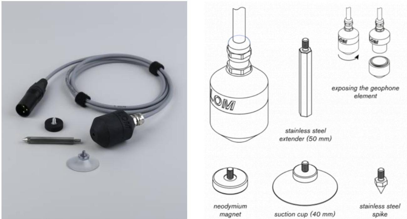
Fig. 4 Photographie du Geofón — gauche — et sa constitution — droite — capsule, aimant en neonymium, ventouse, pic en acier inoxydate, rallonge (LÖM)
