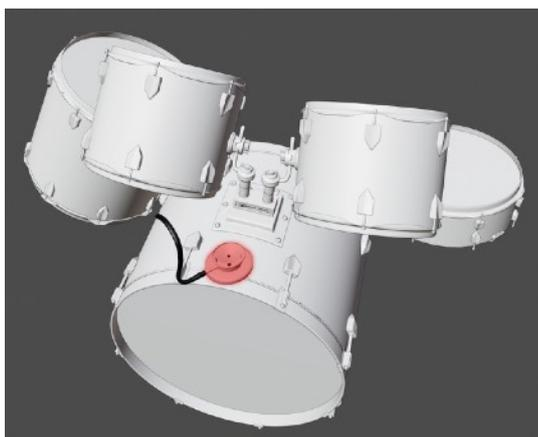
Bien que placé sur la grosse caisse, ce placement présente une fort maintien de la résonance de la caisse claire au niveau de la reprise. Un effet bouché, comme contenu dans une boîte, peut être associé à l'apport esthétique de ce positionnement de capteur. La longue résonance induit un effet de masque relativement important.
