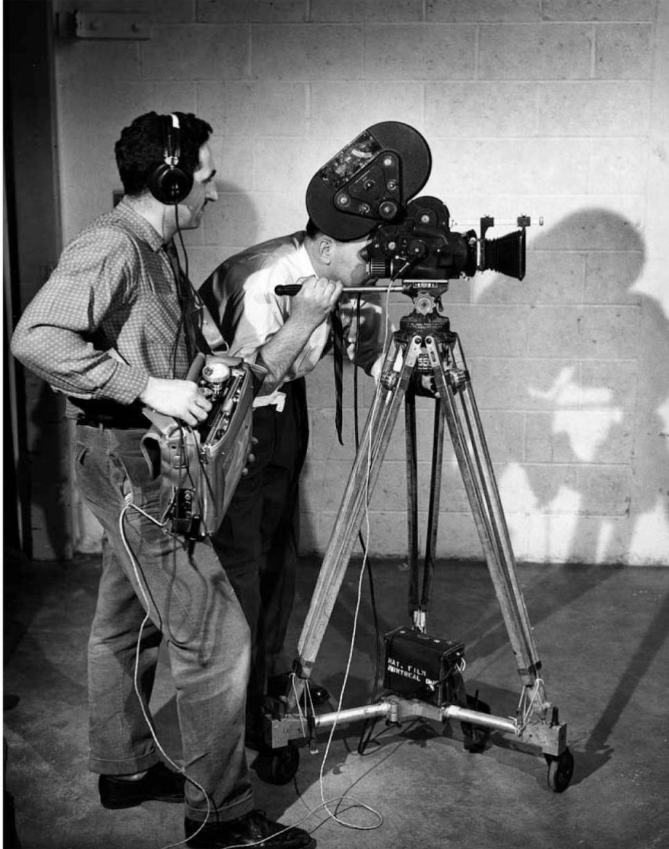
*Fig. 2 : Un système synchrone et léger en 1961 à l'Office National du Film à Montréal. Claude Pelletier tient un Nagra et John Spotton une caméra Arriflex 16 mm (Bouchard, 2012).*
