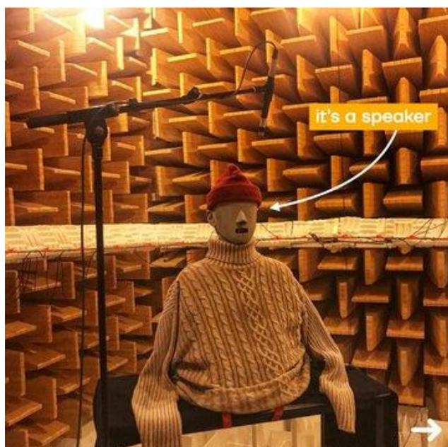
Fig 2.3.5, Simulateur de torse utilisé pour les mesures de Boom-It
