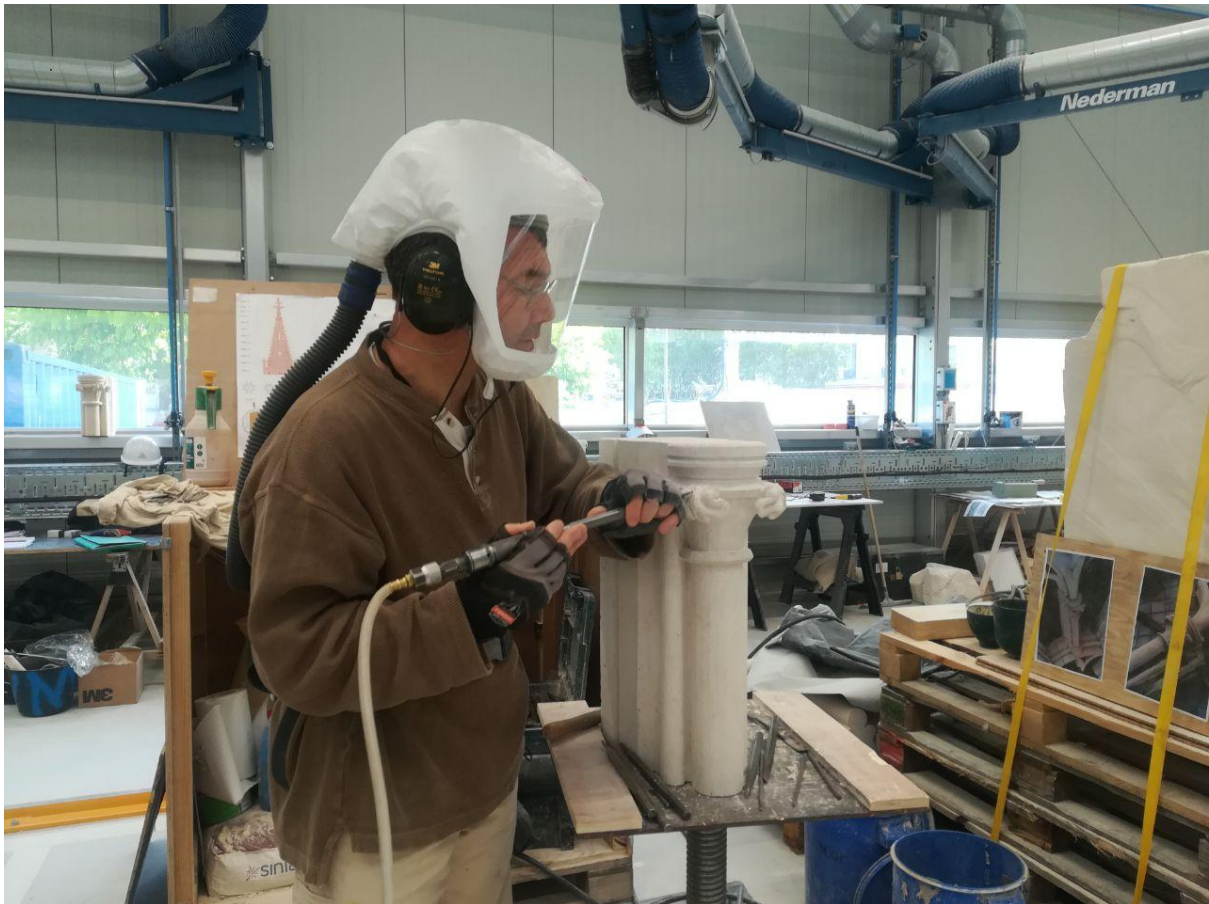
Illustration 7 : Nicolas tailleur de pierre sur le chantier de la cathédrale Notre-Dame de Paris. La soufflerie visible en arrière plan et les outils motorisés des artisan·e·s de l'atelier sont responsables d'un bruit de fond de 80 dB dans l'atelier. Nicolas se protège de la poudre de pierre avec un casque masque ventilé, et du son de son outil, le pétard, avec un casque anti-bruit. (Photographie Camille Tirard, avril 2023)
