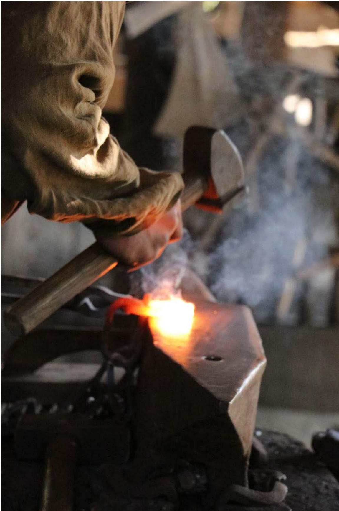
Illustration 37 & 38 : Mathis fabrique une chaîne. Le son de la frappe lui permet de savoir si l'intérieur de la soudure est bien homogène. (© PI2A-Audio, 2023)
