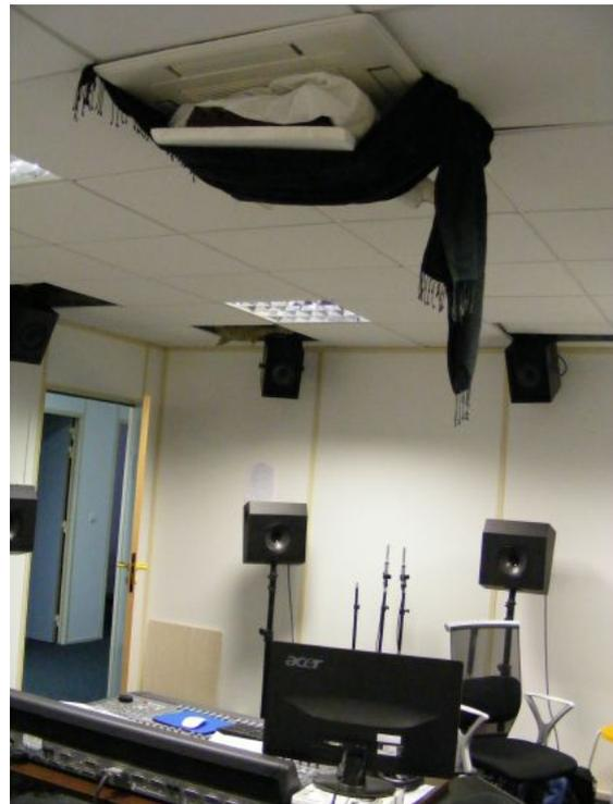
FIGURE 2.3 – Un « hamac acoustique » qui permettait d'étouffer le bruit de la ventilation.
