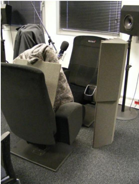
FIGURE 2.2 – Une cabine speak légère pour s'isoler des bruits environnants. La qualité de l'enregistrement des voix a probablement souffert d'un environnement mal adapté.
