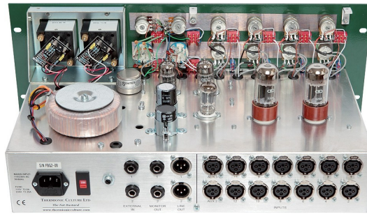
Fig. 10 Sommateur analogique à lampes
