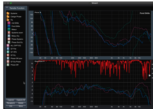
FIGURE 8 – Les trois points de mesures avant égalisation du système
