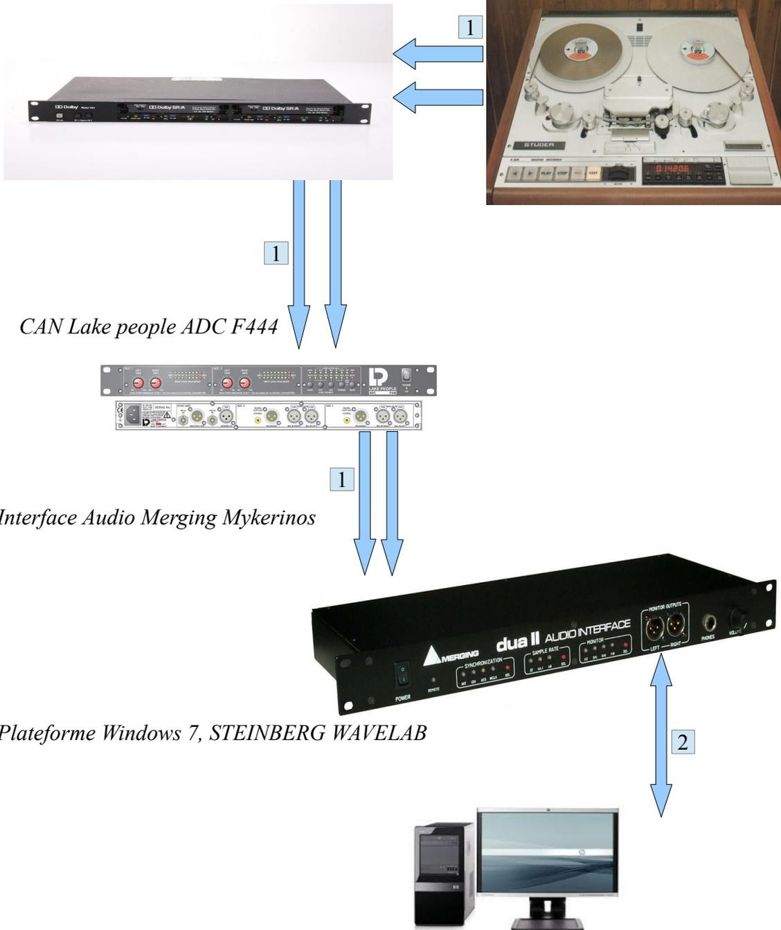
1: Liaisons symétriques analogiques au niveau nominal de +4 dBu entre les sorties lignes du magnétophone Studer A80 et les entrées lignes du Dolby A ; entre les sorties lignes du Dolby A vers les entrées lignes de l'interface audio Merging Mykerinos.
