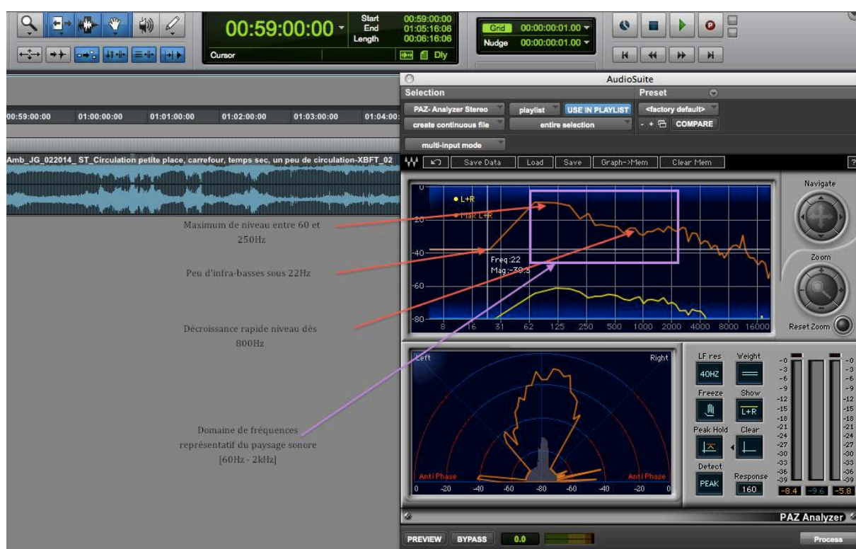
Figure 3 : Analyse fréquentielle d'un enregistrement stéréophonique d'une scène sonore d'un paysage urbain [Niveau = f (fréquence)]
