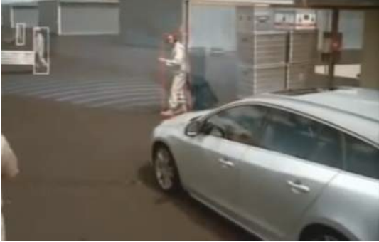
Figure 10 : Système de freinage automatique de Volvo V60 lors de la détection d'un élément étranger sur la trajectoire du véhicule.
