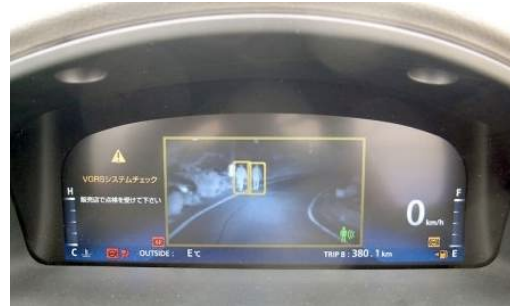
Figure 12bis : Aperçu du système Night View de Toyota qui permet une détection rapide des piétons en vision nocturne.
