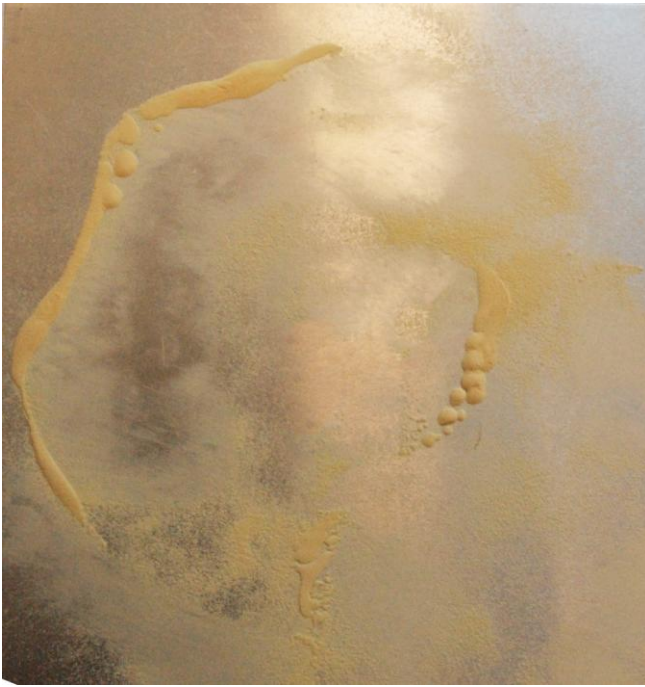
Figure 88 : Formation d'une figure dans la poudre de lycopode sur une plaque en aluminium
