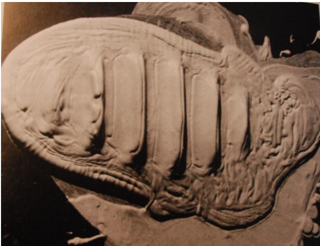
Figure 63 : Résultat de la liquéfaction puis solidification de la pâte de kaolin sur une plaque en vibration
