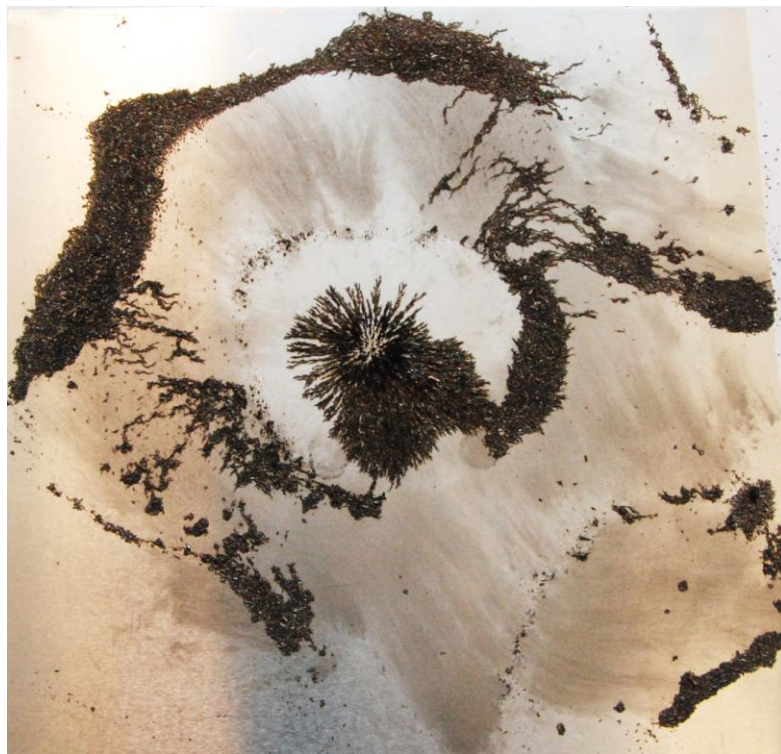
Figure 87 : Action de la vibration sur la limaille de fer
