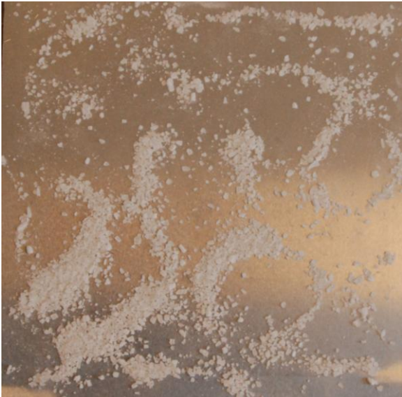
Figure 86 : Fréquence de 1180 Hz avec du gros sel, sur une plaque d'aluminium
