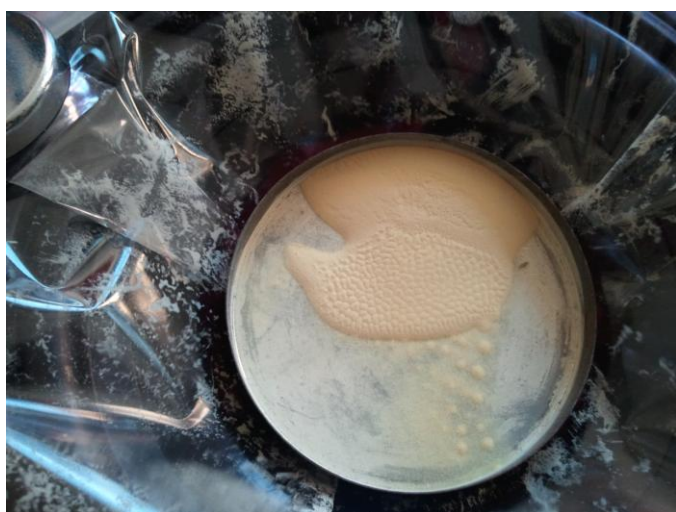
Figure 75 : La poudre de lycopode se rassemble pour former la demi-sphère
