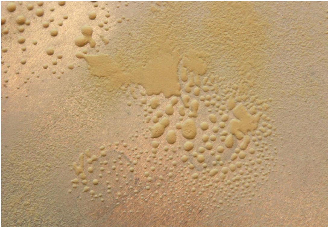
Figure 89 : Formation d'amas en rotation dans la poudre de lycopode mise en vibration
