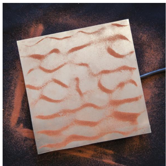
Figure 82 : Fréquence de 1610 Hz sur une plaque carrée
