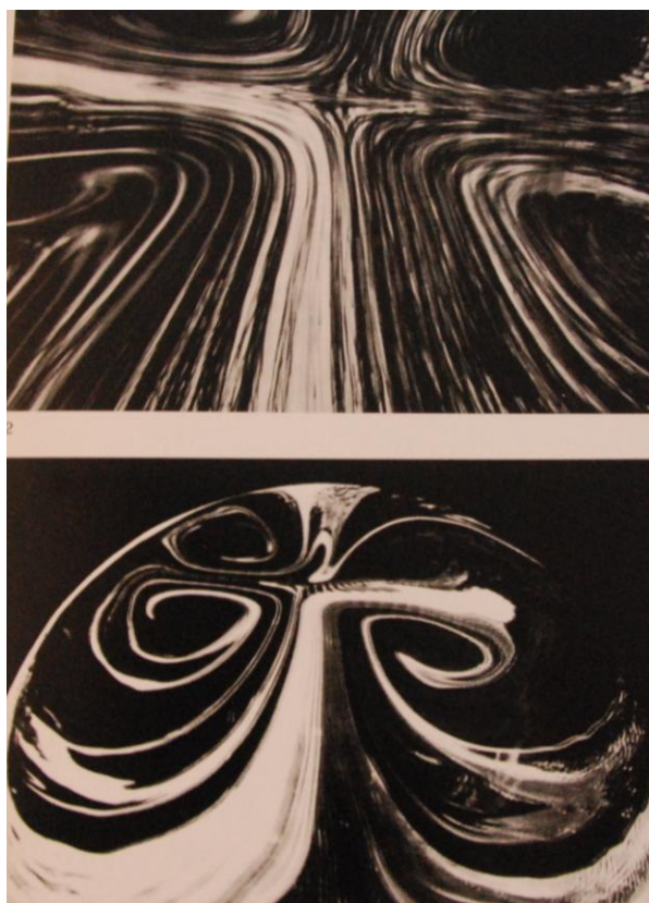
Figure 52 : Utilisation de l'encre pour révéler les mouvements vibratoires
