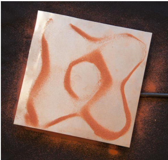
Figure 80 : Fréquence de 335 Hz sur une plaque en aluminium de 20 x 20 cm
