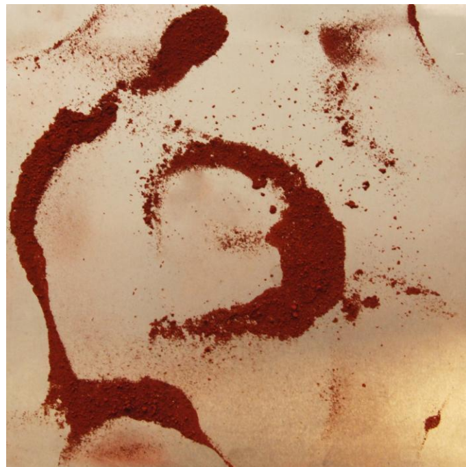
Figure 85 : Fréquence de 510 Hz visualisée par des pigments rouges sur une plaque en aluminium
