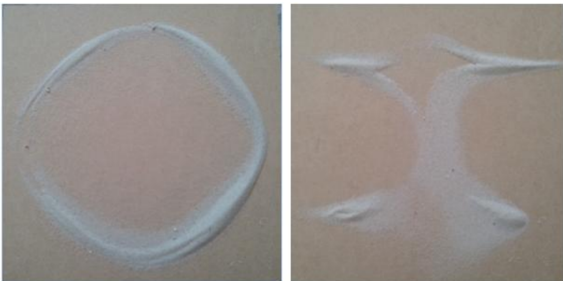
Figure 78 : Fréquences de 210 et 320 Hz diffusées sur une plaque de 3mm de MDF
