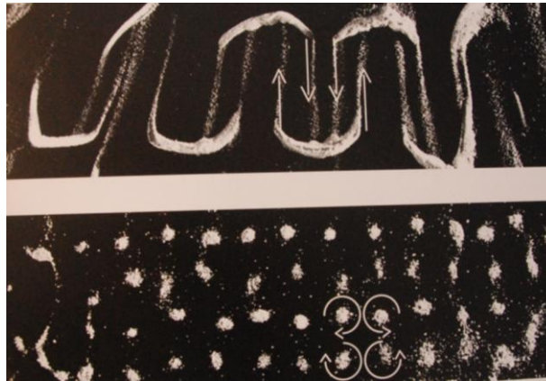
Figure 59 : Allers retours et rotations du sable sur les plaques de métal
