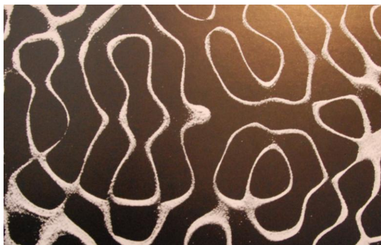
Figure 56 : Apparition de nouvelles formes due à la non-uniformité de la plaque
