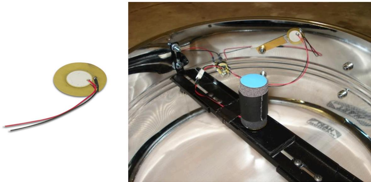
**Figure 5 : (gauche) Disque piézoélectrique, (droite) Disque piézoélectrique utilisé pour une détection d'attaque sur un élément de batterie**
