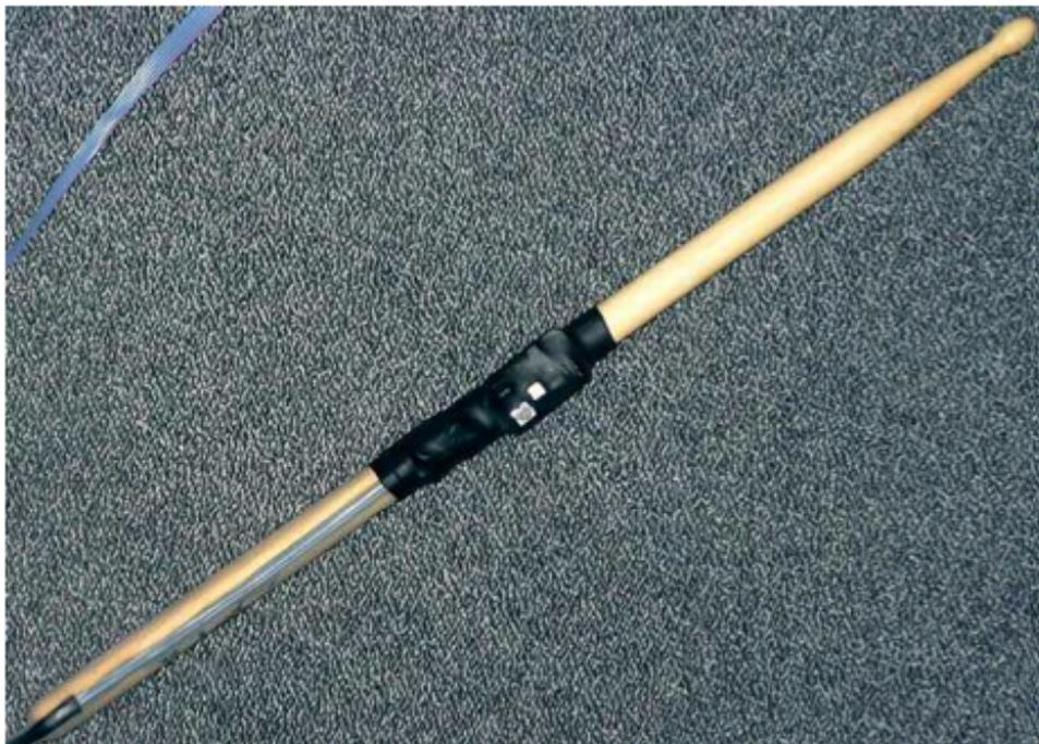
**Figure 11 : Capteurs inertiels embarqués sur une baguette, par Charles Verron**
