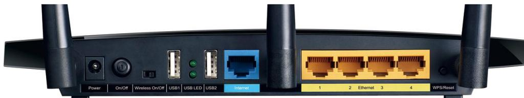
FIGURE 1.2 – Connecteurs et antennes du TP-Link WDR4300 (*source : tp-link.com*)
