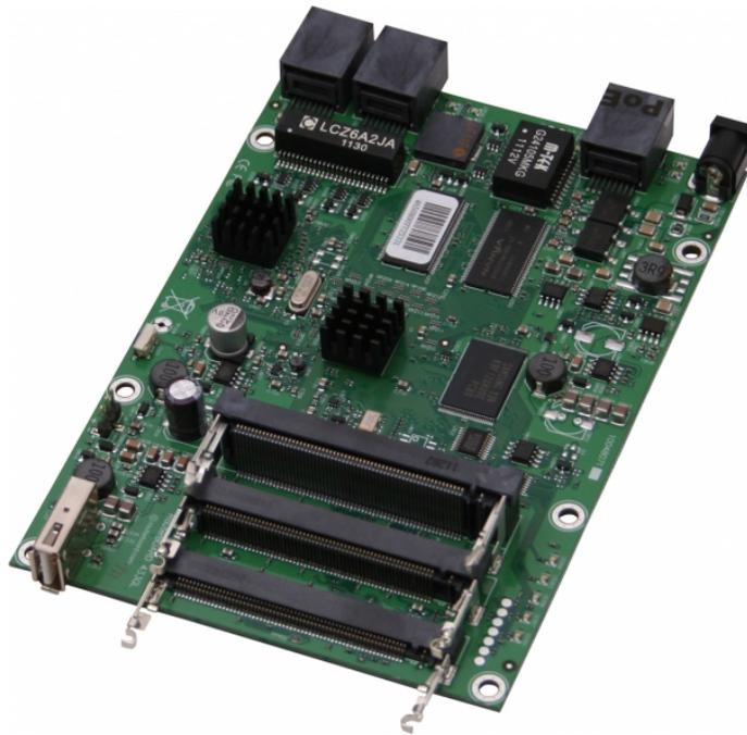
FIGURE 3.3 – Routeur MIKROTIK RB433GL (*source : mikrotik-shop.de*)
