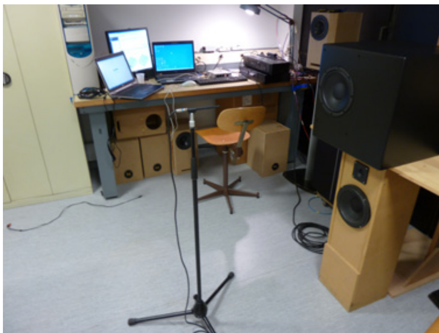
FIGURE 2.2 – Dispositif de mesure de l'enceinte à l'ENS Louis-Lumière.
