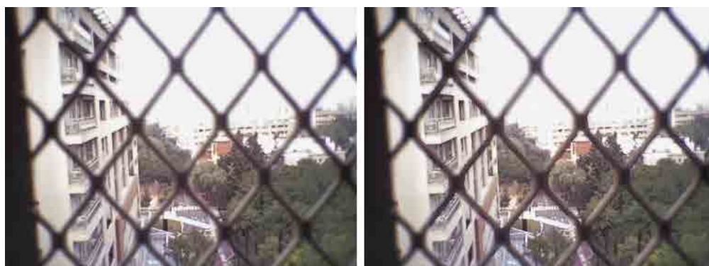
Figure 49 : Une image obtenue par interpolation (à gauche) et une autre obtenue par utilisation d'une carte de profondeur (à droite). On distingue clairement les artefacts que la seconde méthode produit.
