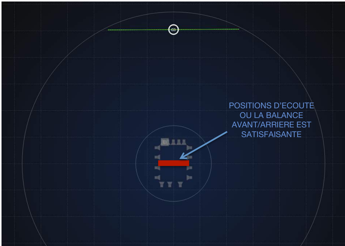
Fig. 2.17 : En restitution discrète, une ligne horizontale décrit la zone d'écoute où une bonne balance avant/arrière est perçue. En arrière de cette zone, les canaux perçus sont perçus plus intensément.
