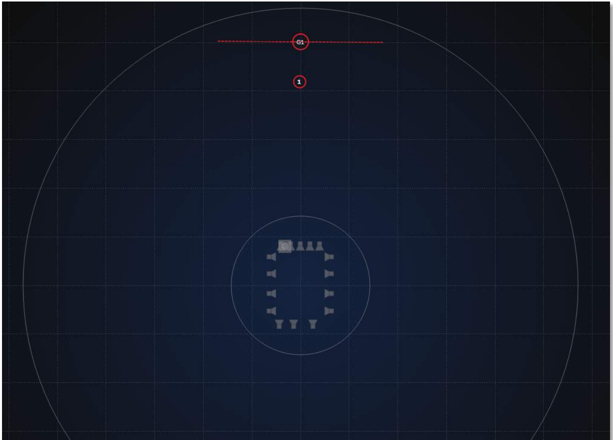
Fig. 2.10 : Deuxième configuration : objet WFS au niveau du deuxième cercle du Performer, groupe de réverbération (stéréo) derrière la source et relativement proche de celle-ci, largeur du groupe « réverbération » reconsidérée.
