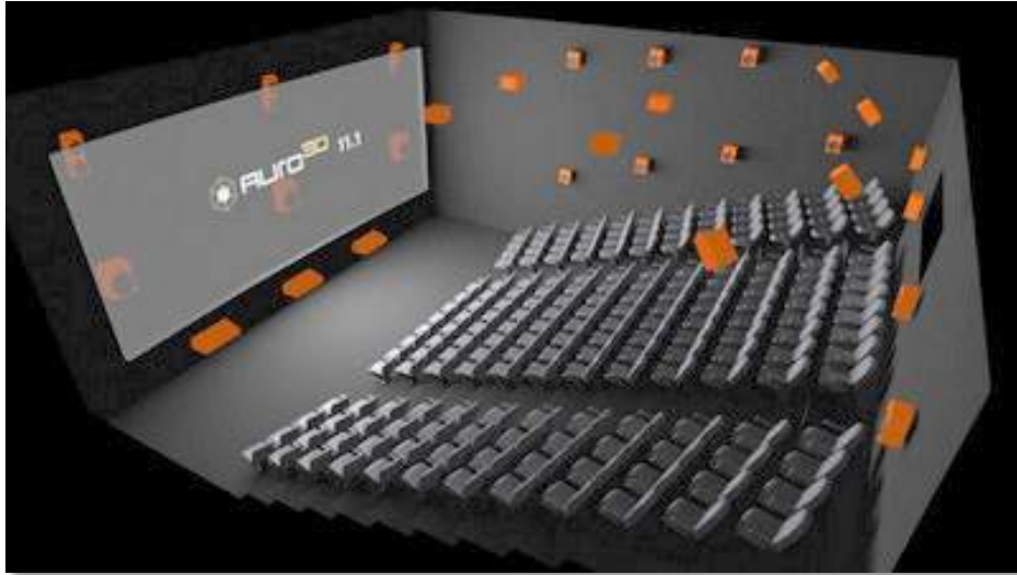
Fig. 1.16 : Configuration Auro 3D 13.1 dans une salle de cinéma. On imagine que l'installation des haut-parleurs situés en hauteur peut devenir complexe pour les salles basses de plafond. Source : www.auro-3d.com .
