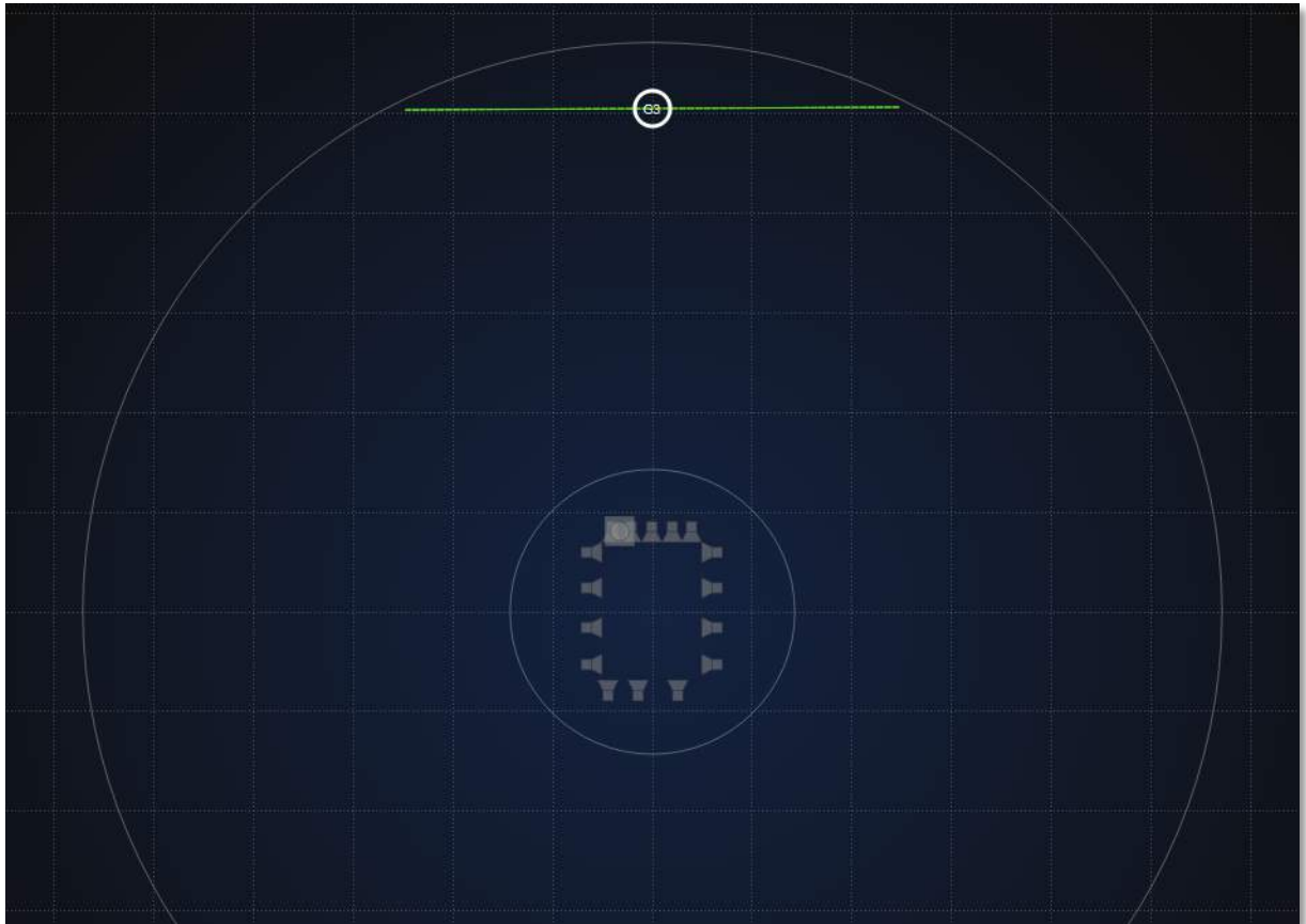
Fig. 2.13 : Position 3 : groupe bipolaire "ambiance" au niveau du second cercle du Performer ; largeur du groupe reconsidérée.
