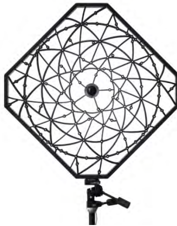
Exemple de réseau de microphones avec plusieurs valeurs de rayons (40 microphones), 1,8m de diamètre
