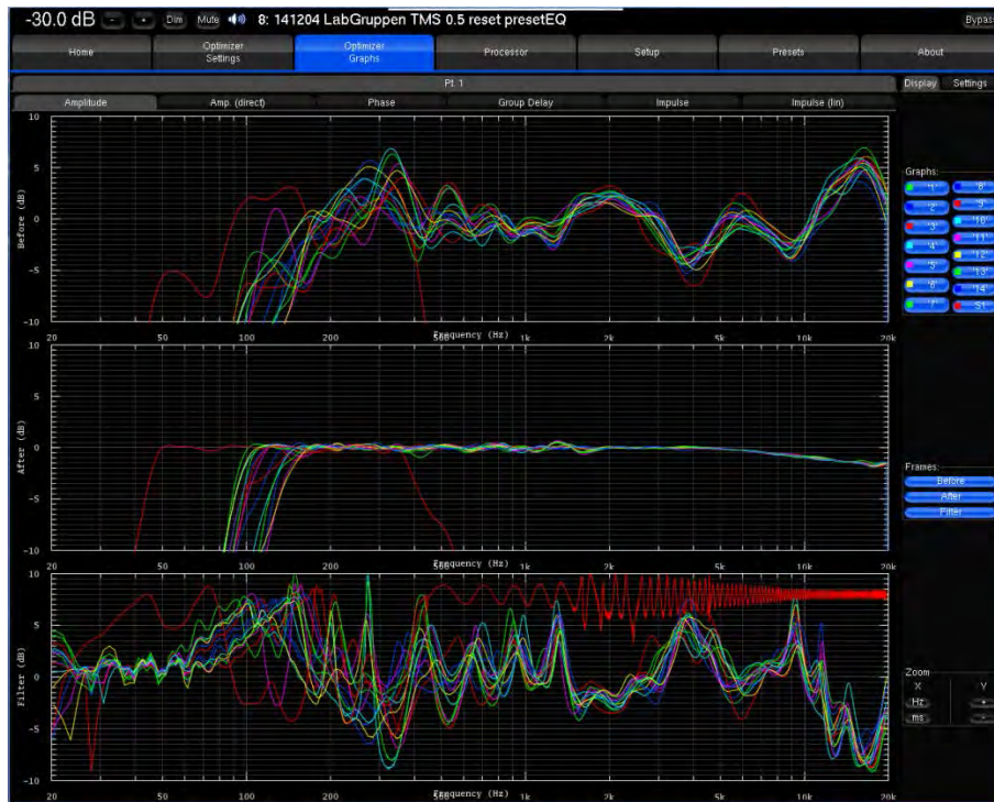
Egalisation effectuée par l'Optimizer (les 15 courbes d'entrée sont en haut, au milieu les courbes de sortie, en bas les filtres appliqués)
