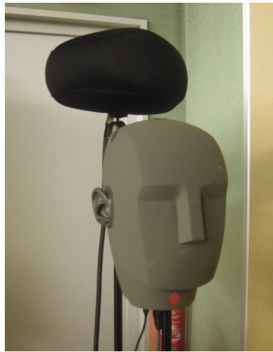
FIGURE 6 : TÊTE ARTIFICIELLE KU100 SURMONTÉE DU MICROPHONE DPA 5100.
