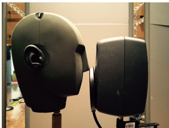
FIGURE 10 : PRISE DE SON, PAR UNE TÊTE ARTIFICIELLE, D'UNE VOIX MONO DIFFUSÉE PAR ENCEINTE
