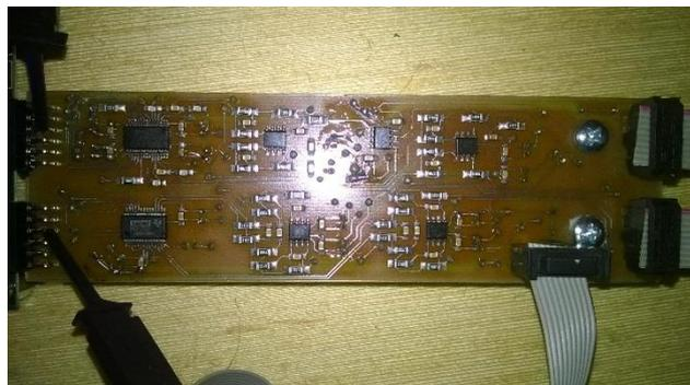
Figure 2 : Photographie du convertisseur sigma-delta (2,8224 MHz/1 bit) réalisé dans le cadre de ce travail (4,3 cm x 14,6 cm x 1,5 cm).
