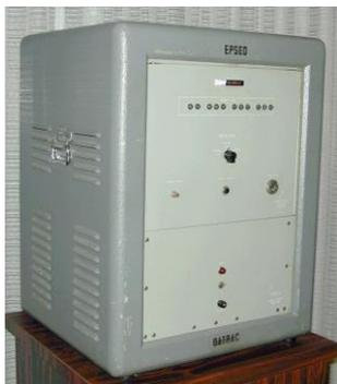
Figure 1 : Photographie du "datrac" (PCM 50 kHz/11 bits) développé par Bernard M. Gordon en 1954 (48 cm x 38 cm x 68 cm, 68 kg) (d'après [1], figure 1.17 p.1.22).
