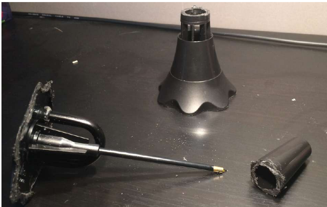
FIGURE 42 – Sourdine Yamaha ouverte dévoilant la cavité intérieure, le tuyau courbé et au milieu, traversant la sourdine de part en part, les conducteurs reliant le capteur à la connectique.
